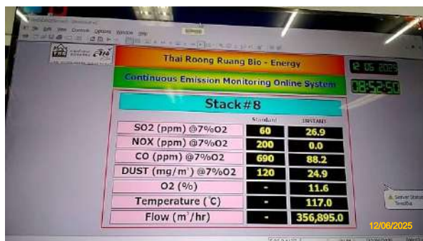
รูปที่ 2-20 เครื่องมือหรืออุปกรณ์พิเศษ รายงานมลพิษจากปล่องหม้อไอน้ำ (CEMs)
